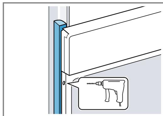
3. Fixer l'appareil avec une vis adéquate.
