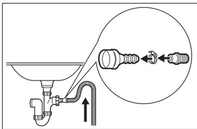
Veillez à ce que le tuyau de vidange fasse une boucle afin d'éviter que des particules passent de l'évier à l'appareil.
