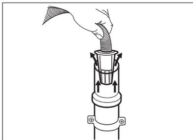
4. À une conduite fixe dotée d'une ventilation spéciale : insérez directement le tuyau dans le tuyau de vidange. Reportez-vous à l'illustration.
