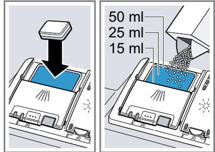
Une pastille suffit, le cas échéant. Déposez la pastille en diagonale. Si vous utilisez du détergent en poudre ou liquide, observez les indications de dosage du fabricant et la graduation du dosage du compartiment à détergent.
