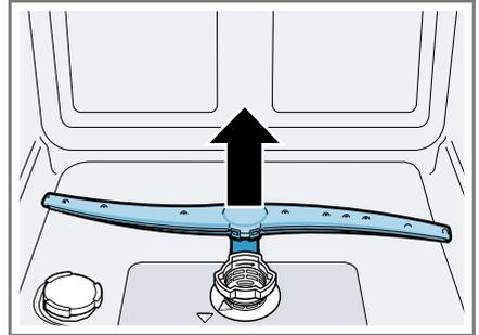
2. Sous l'eau courante, s'assurer que les buses de sortie du bras d'aspersion sont dégagées et éliminer les corps étrangers au besoin.
