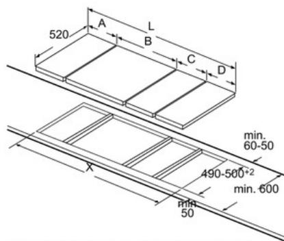
En cas d'encastrement de deux ou de plusieurs éléments Domino les uns à côté des autres ou si plusieurs sets de montage sont requis (2 éléments, 1 set de montage, 3 éléments, 2 sets de montage, etc.).
