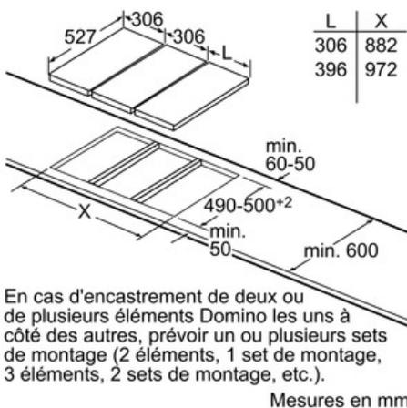
En cas d'encastrement de deux ou de plusieurs éléments Domino les uns à côté des autres, prévoir un ou plusieurs sets de montage (2 éléments, 1 set de montage, 3 éléments, 2 sets de montage, etc.).
