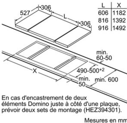
En cas d'encastrement de deux éléments Domino juste à côté d'une plaque, prévoir deux sets de montage (HEZ394301).
