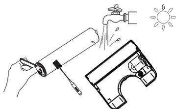
Utilisez l'outil de nettoyage pour retirer les cheveux et les débris enroulés autour du rouleau et rincez celui-ci ainsi que l'arrière du REP à l'eau. Laissez-les sécher complètement avant de les remettre en place.
