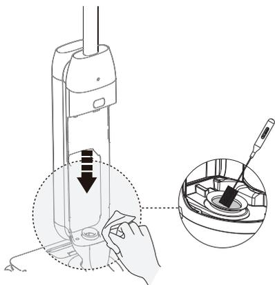
Nettoyez le capteur de poussière avec un chiffon humide ou l'accessoire de nettoyage.
