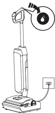
1. Placez l'appareil sur la station de recharge après l'utilisation, le capteur détecte automatiquement le niveau de saleté.
