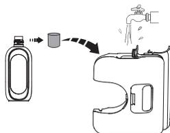
Ouvrez le bouchon du réservoir et remplissez ce dernier d'eau du robinet. Si un nettoyage en profondeur est nécessaire, ajoutez un bouchon de flacon de solution dans le REP et fermez fermement le bouchon.
