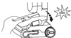
Replacez le réservoir dans l'appareil. Vous entendrez un clic lorsque le réservoir est bien en place.
