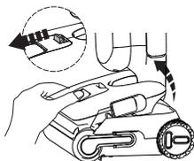
Appuyez sur le bouton de déverrouillage du réservoir d'eau propre pour le retirer de l'appareil.
