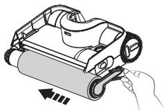
Remettez le rouleau brosse en place en insérant son extrémité dans le côté gauche du support, puis fixez la languette du rouleau à la boucle magnétique à droite pour la verrouiller en place.
