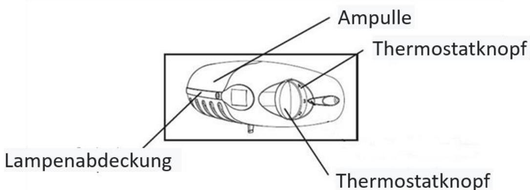
Ihr Kühlschrank ist mit einem Thermostat ausgestattet, der sich im Inneren des Geräts befindet.
