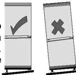
Si el aparato no está nivelado, la junta de la puerta y la alineación magnética se verán afectadas. Una vez colocado el aparato en su posición definitiva, ajuste los pies ajustables de la parte delantera girándolos.
