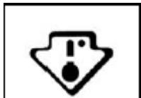
In Ihrem Kühlschrank befindet sich nebenstehendes Symbol. Es gibt eindeutig den kältesten Bereich im Gerät an. Die Temperatur ist dort unter oder gleich + 4°C. In diesem Bereich ermöglicht eine Temperaturanzeige die korrekte Einstellung des Kühlschranks.
