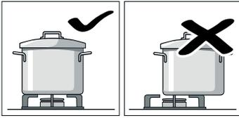
Le plat doit systématiquement être placé au milieu de la plaque, sinon il risque de se renverser.
