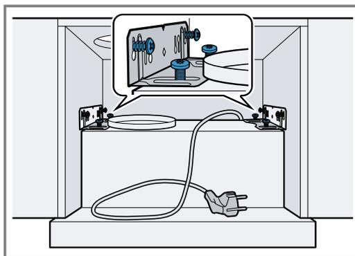
2. Largeur de l'appareil 90 cm : tirez le tiroir-filtre complètement vers l'avant. Vissez également l'appareil sur les meubles supérieurs latéraux par le bas avec 2 vis chacune à gauche et à droite.
