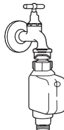
Tuyau d'arrivée d'eau sécurisé
