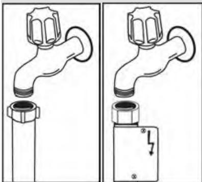
**NOTE :** Un système anti-débordement Aquastop est utilisé dans certains modèles. Si un Aquastop est utilisé, une tension élevée existe. Ne coupez pas le système anti-débordement Aquastop. Ne le pliez pas et ne le tordez pas.
