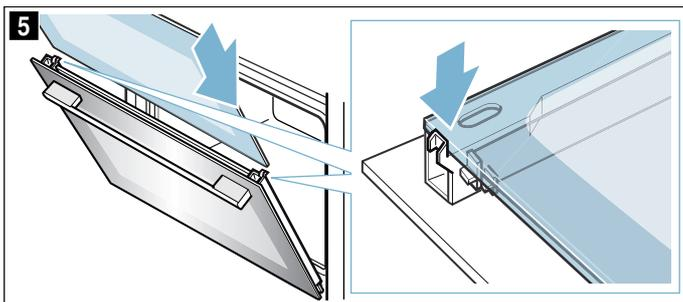
6. Poser le recouvrement et appuyer dessus jusqu'à ce qu'il s'encliquette de manière audible (fig. 6).
