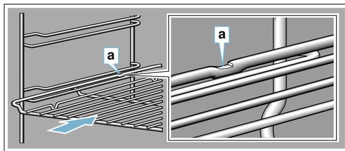
En introduisant des plaques, veillez à ce que le taquet d'arrêt **a** soit à l'arrière et orienté vers le bas. La partie inclinée de l'accessoire **b** doit être orientée vers l'avant en direction de la porte de l'appareil.
