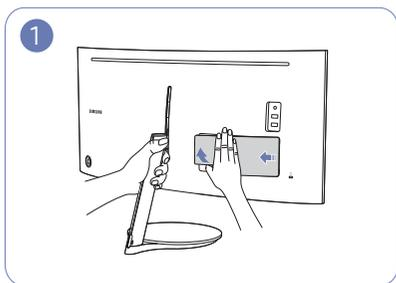
Tenez le socle d'une main et utilisez le pouce de l'autre main pour retirer la PARTIE SECONDAIRE ARRIÈRE DU CAPOT dans le sens de la flèche.
