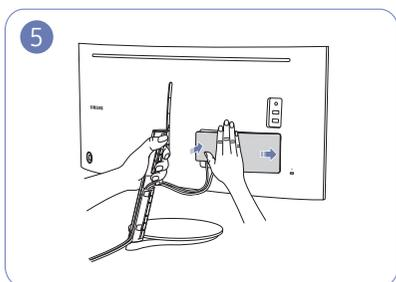
Tenez le socle d'une main et utilisez l'autre main pour fermer la PARTIE SECONDAIRE ARRIÈRE DU CAPOT dans le sens de la flèche.
