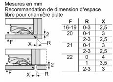
Les dimensions d'espace libre recommandées dans le tableau doivent être respectées afin d'assurer une ouverture sans collision des portes de l'appareil, et d'éviter ainsi d'endommager les meubles de cuisine.
