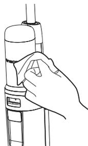
Utilisez un chiffon pour nettoyer la surface avec un détergent neutre. Le chiffon doit être sec pour éviter que de l'eau ne pénètre dans l'appareil.
