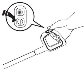
Appuyez sur le bouton ① pour que l'appareil démarre en mode AUTO par défaut. Appuyez à nouveau sur ce bouton pour éteindre l'appareil. Alternez entre les modes AUTO, MAX et SUCTION en appuyant sur le bouton
