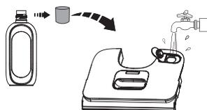
Ouvrez le bouchon du réservoir et remplissez-le d'eau du robinet. Si un nettoyage en profondeur est nécessaire, ajoutez un bouchon de flacon de solution dans le REP et fermez fermement le bouchon.
