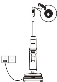
1. Placez l'appareil sur la station de recharge après l'utilisation, le capteur détecte automatiquement le niveau de saleté.
