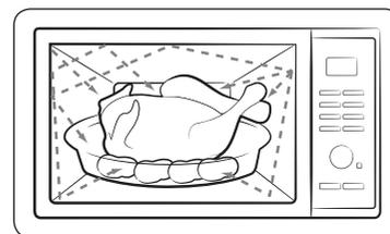
1. Les micro-ondes générées par le magnétron sont réfléchies sur les parois du four et réparties de façon homogène à l'intérieur du four pendant la cuisson grâce à la rotation du plateau sur lequel sont placés les produits. Ce procédé assure donc une cuisson homogène des aliments.
