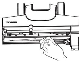
Retirez les cheveux et les débris du compartiment du rouleau brosse et de l'ouverture à l'aide d'une lingette ou d'un chiffon humide.
