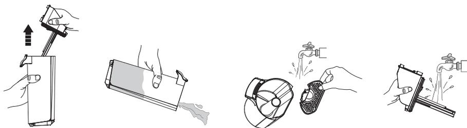
Si le couvercle du réservoir d'eau sale et le filtre à l'intérieur sont obstrués, retirez-les et rincez-les deux à l'eau.
