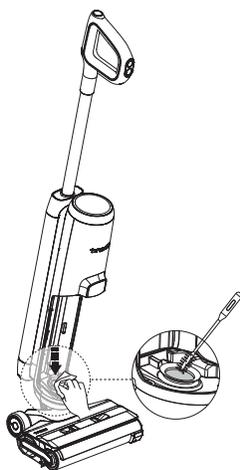
Retirez le réservoir d'eau sale, nettoyez l'orifice d'eau sale à l'aide d'un chiffon humide ou de l'outil de nettoyage pour éviter qu'il ne se bouche.
