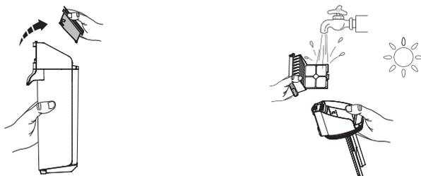
Saisissez les zones en creux de chaque côté du filtre sec et tirez vers le haut. Rincez sous l'eau courante et laissez sécher complètement avant de replacer le filtre sec dans le couvercle du RES.
