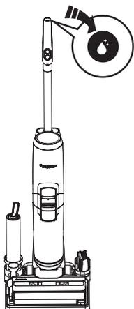
1. Placez l'appareil sur le plateau de rangement et branchez-le. Maintenez le bouton de nettoyage automatique enfoncé et démarrez le processus.
