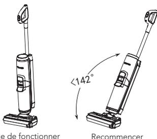
L'appareil s'arrêtera de fonctionner en position verticale et recommencera à fonctionner lorsque vous l'inclinerez.
