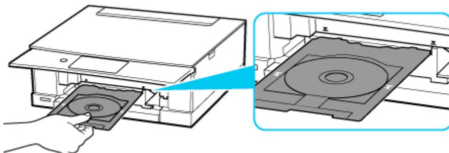
15. Insérez le tiroir multifonctions directement à l'horizontale jusqu'à ce que la flèche (▼) du guide tiroir multifonctions soit à peu près alignée avec la flèche (▲) située sur le tiroir multifonctions.
