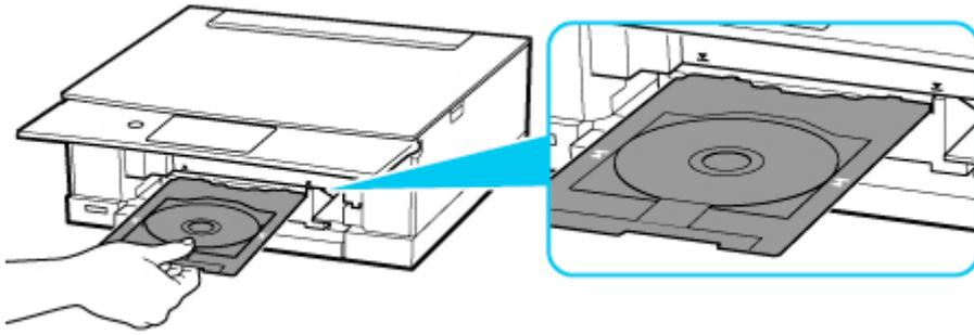
4. Insérez le tiroir multifonctions directement à l'horizontale jusqu'à ce que la flèche (▼) du guide tiroir multifonctions soit à peu près alignée avec la flèche (▲) située sur le tiroir multifonctions.
