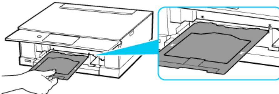
4. Insérez le tiroir multifonctions directement à l'horizontale jusqu'à ce que la flèche (▼) du guide tiroir multifonctions soit à peu près alignée avec la flèche (▲) située sur le tiroir multifonctions.
