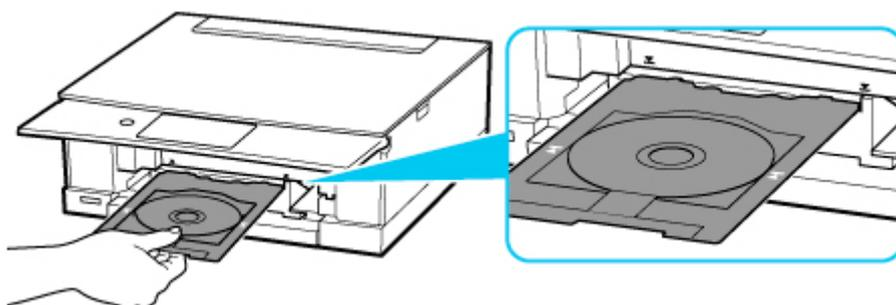
14. Insérez le tiroir multifonctions directement à l'horizontale jusqu'à ce que la flèche (▼) du guide tiroir multifonctions soit à peu près alignée avec la flèche (▲) située sur le tiroir multifonctions.
