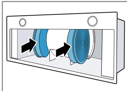
4. Zamontować filtry przeciwłuszczowe.
