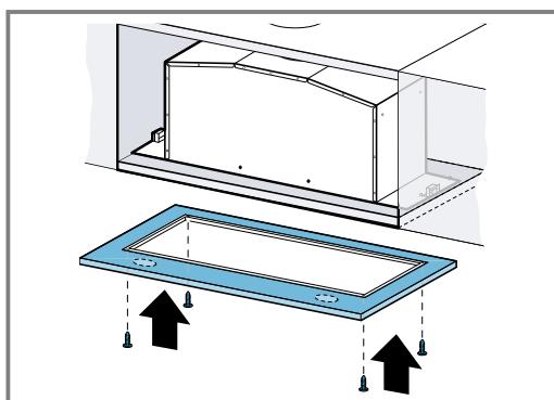
**4. Ramę i urządzenie zabezpieczyć śrubami.**
