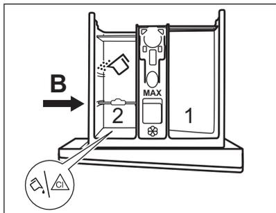
La position **B** du séparateur de produit de lavage est destinée à la lessive en poudre dans le compartiment arrière, et à la lessive/aux additifs liquides ou à un agent blanchissant dans le compartiment avant.
