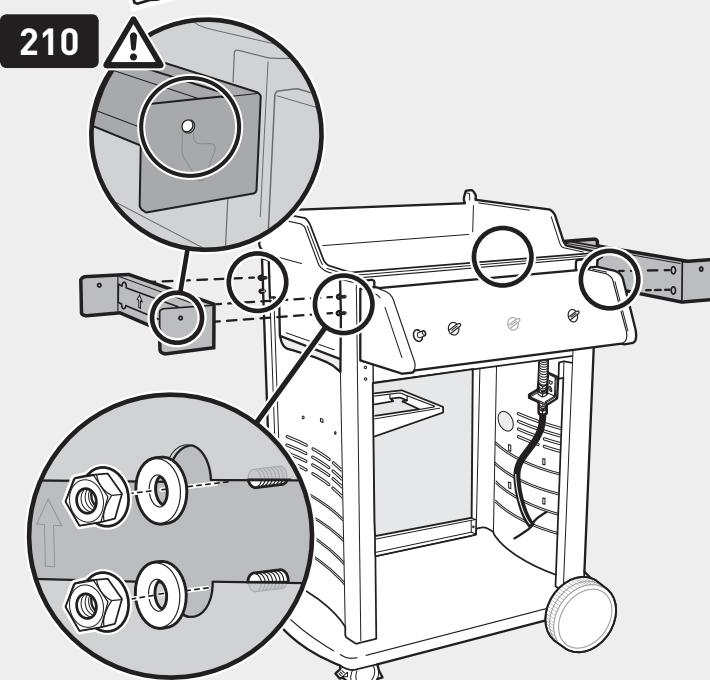
Draai de moeren handvast. Draai ze vervolgens nog een kwartslag. NIET TE STRAK VASTDRAAIEN.
