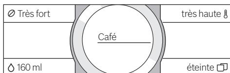
**i** Les possibilités de réglage varient selon les boissons. Alors que pour les boissons à base de café, il est possible de régler p. ex. l'intensité du café, la température et la quantité de café, il n'est réglable, pour le lait, que la contenance.
