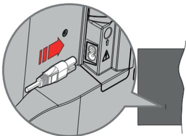
Branchez une extrémité (la fiche à deux trous) du cordon d'alimentation détachable fourni dans l'entrée du cordon d'alimentation située à l'arrière de la TV, comme indiqué ci-dessus. Branchez ensuite l'autre extrémité du cordon d'alimentation dans la prise de courant. Le téléviseur s'allume automatiquement.
