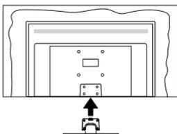
3. Insérez les vis fournies (M4 x 12), puis serrez-les tout doucement jusqu'à ce que le support soit correctement fixé.
