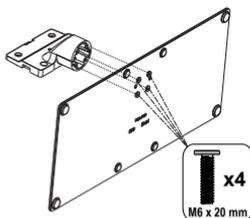
2. Installez le(s) support(s) sur le modèle de montage du support à l'arrière du téléviseur.
