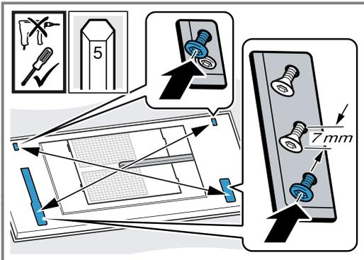
Visser les vis une par une pour que l'appareil ne se déforme pas dans la découpe.
