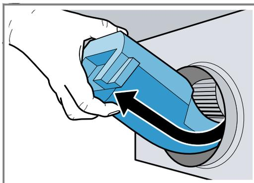
2. Retirez les résidus de polystyrène du compartiment intérieur de l'appareil.
