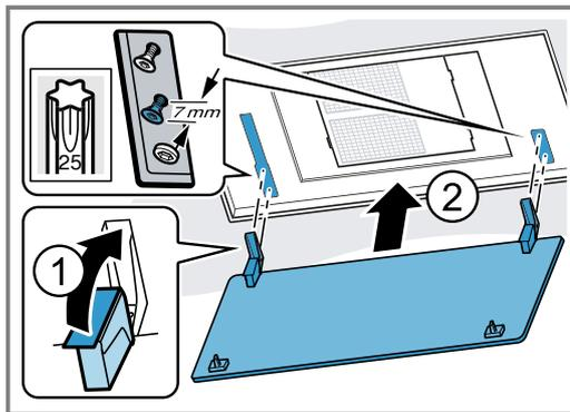
2. Accrochez le capot du filtre sur les vis prévues et poussez-le vers l'arrière/l'avant selon la forme du trou de serrure dans le rétrécissement.
