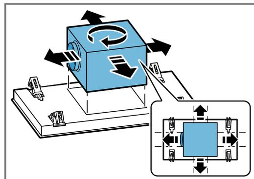
5. Faites glisser le coffre du ventilateur sur le côté et raccordez l'appareil à l'alimentation électrique.
