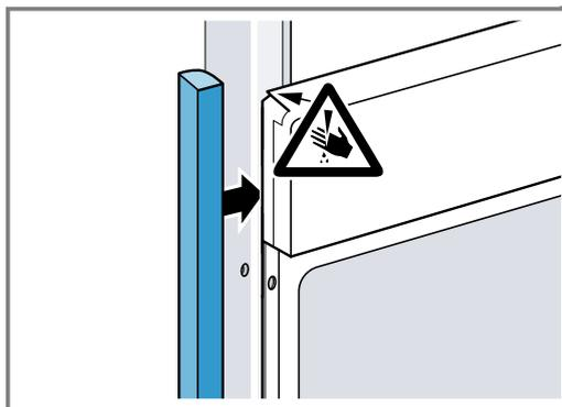
2. Pré-percer les profilés en aluminium pour réaliser un raccord à vis.
