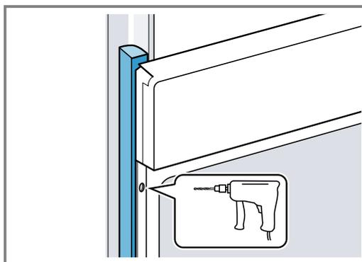
3. Fixer l'appareil avec une vis adéquate.
