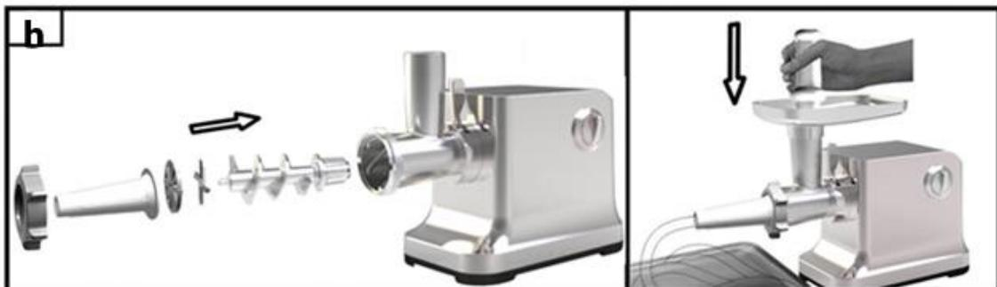
h) Il vous faut l'embout de préparation de saucisses (13). Placez l'hélice (8) comme d'habitude par son bout épais dans le boîtier de l'hélice (7). Posez la lame (9) et la grille (10, 11 ou 15) sur l'hélice. Placez ensuite l'embout de préparation de saucisses (13) sur la lame (9) et la grille (10, 11 ou 15). Bloquez la bague de fixation en la tournant (12).
