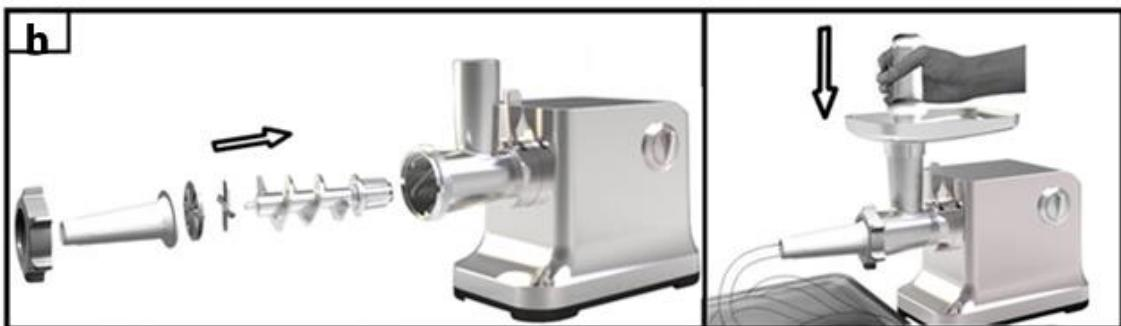
h) Para la producción de embutidos requerirá la boquilla para embutidos (13). Coloque el sinfín de compresión (8) como de costumbre con el extremo más grueso primero en el tubo colector (7). Coloque la cuchilla (9) y el disco perforado (10, 11 o 15) sobre el sinfín de compresión. A continuación, coloque la boquilla para la producción de embutidos (13) sobre la cuchilla (9) y disco perforado (10, 11 o 15). Apriete el anillo de fijación (12).
