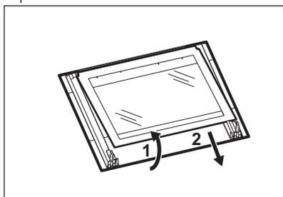
8. Nettoyez les panneaux de verre avec de l'eau savonneuse. Séchez soigneusement les panneaux de verre. Les rails télescopiques ne passent pas au lave-vaisselle.
