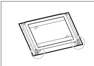
5. Désengagez le système de verrouillage pour retirer les panneaux de verre intérieurs.
