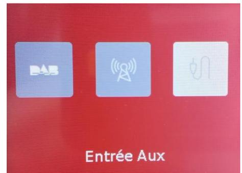
Une fois dans ce mode "Entrée Aux", le seul réglage à effectuer consiste à régler le niveau de sortie de la source audio connectée à l'entrée **AUX IN** [12] de votre DR7+. La méthode la plus simple est la suivante : réglez le volume de sortie de la source audio de telle sorte que le niveau sonore de votre DR7+ soit à peu près identique au niveau sonore en réception DAB+ ou FM, pour un même réglage de volume de la DR7+.
