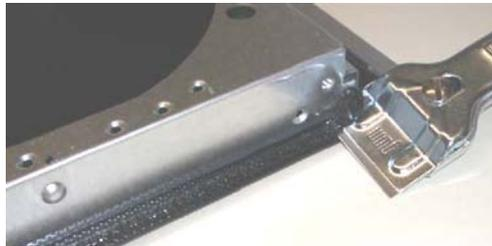
3. Retirer le film de protection du scotch double face sur la baguette profilée.
