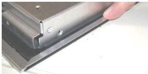
5. Coller le joint de remplacement derrière le profil sur la vitrocéramique. Faire légèrement chevaucher les extrémités au-dessus du joint mousse.
