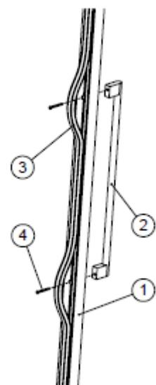
③ Les visser à l'aide d'un tournevis ④ Remettre le joint de la porte en place pour couvrir les vis.
