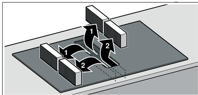
3. Insérez deux des filtres à charbon actif ou des filtres acoustiques dans l'appareil à gauche et à droite et poussez-les vers l'avant.
