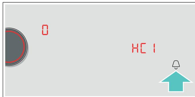
4. Réglez, avec le commutateur rotatif, la valeur **1** « Connexion automatique » ou la valeur **2** « Connexion manuelle ».
